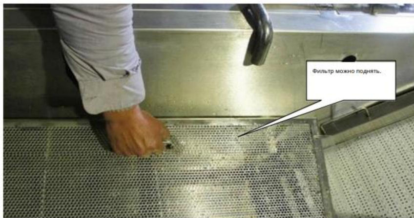
Рис4 Фильтр сетка на дне ванны.
